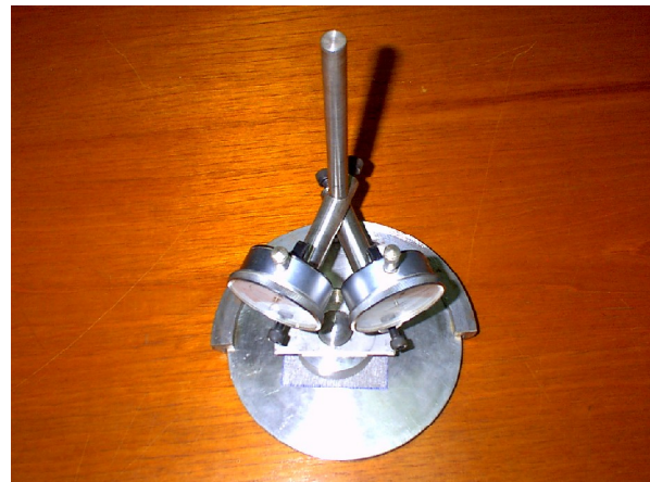
Placa de referencia, pie de presión con tetón, porta flexímetros, flexímetros y geotextil
