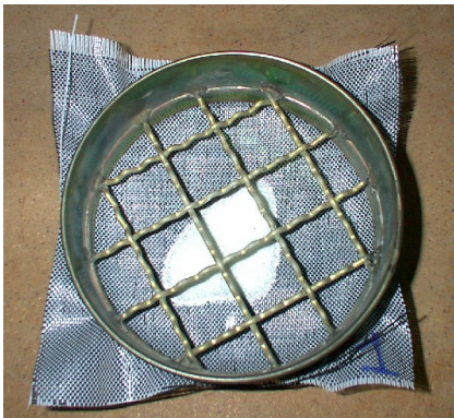
Geotextil preparado para ser ensayado
