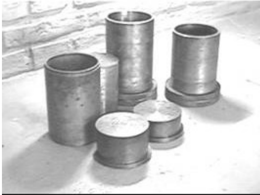
Fotografía 1. Moldes Marshall Modificado
