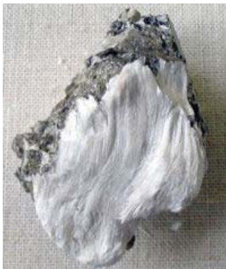
Foto 1: fibras de asbestos en muscovita
