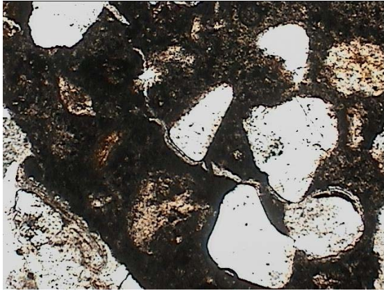
Figura 1- Mortero sin adición de catalizador. Geles y fisuras de RAS
