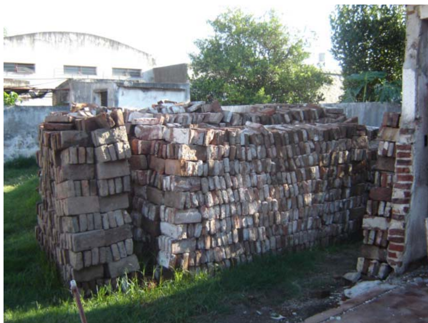
Figura 4: Ladrillos recuperados de una obra de demolición que serán utilizados en la nueva construcción.
