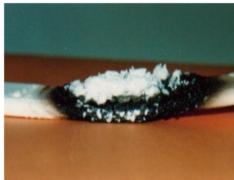
Figura 1. Películas de pinturas intumescentes luego de la acción del fuego
