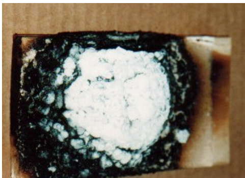
Figura 1. Películas de pinturas intumescentes luego de la acción del fuego
