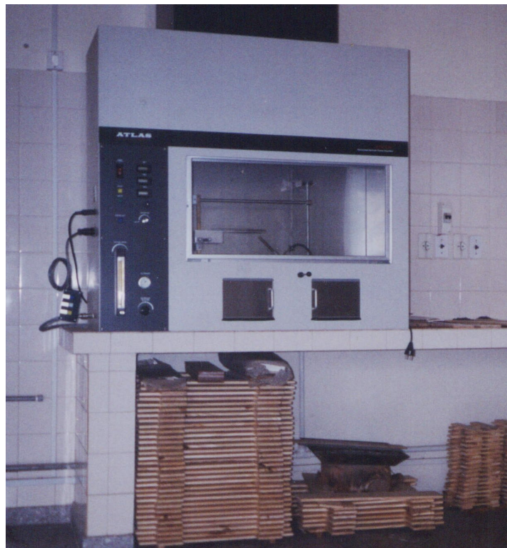
Figura 3. Cabina Horizontal Vertical para ensayo de llama intermitente
