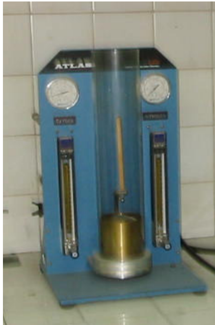
Figura 2. Cámara LOI (Limiting Oxygen Index)
