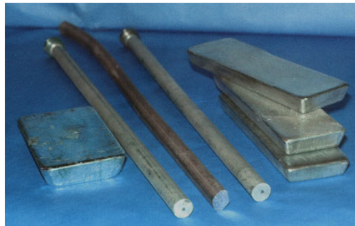
Figura 5. Diferentes formas de ánodos de sacrificio
