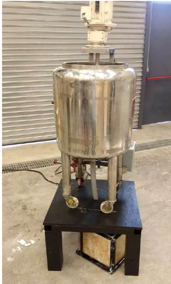
Fig. 5. Bach mezclador montado sobre una base y el molde debajo para la descarga del yeso.
