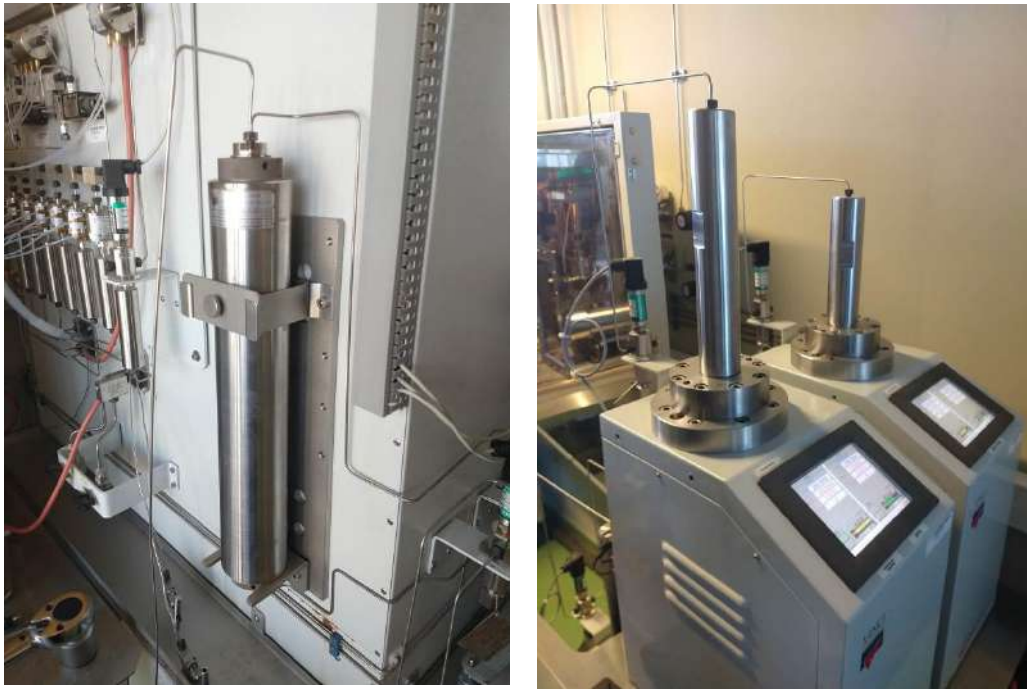
Fig. 7(a) a la izquierda, embolo inyector del fluido de fractura. Fig. 7(b) a la derecha, bomba con control de caudal.
