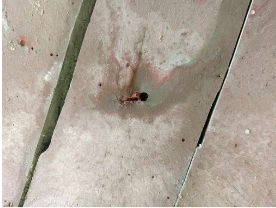
Fig. 16. Detalle del conducto capilar en la muestra generado por la tanza.
