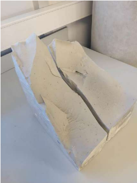
Fig. 11(a) a la izquierda, plano de fractura. Fig. 11(b) a la derecha, tinte azul alrededor del orificio del caño.
