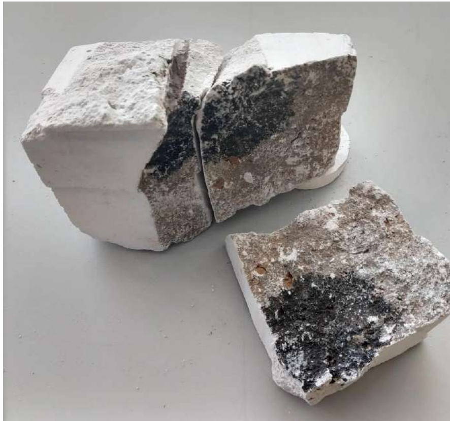
Fig. 3. Fragmentos del bloque donde se observa el plano de fractura a partir del orificio de inyección del tubo.
