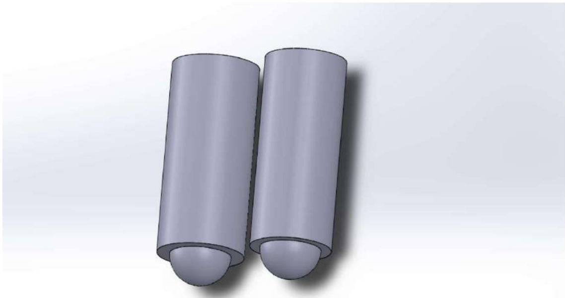
Fig.7 - Modelo 3D de los penetradores que se alojan en el cilindro
