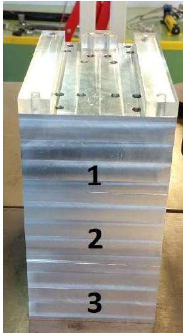
Fig.6- Vista frontal del dispositivo armado, los tres bloques, más los sujetadores acrílicos
