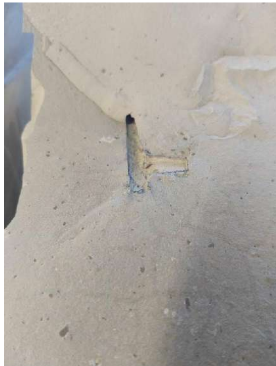
Fig. 11(a) a la izquierda, plano de fractura. Fig. 11(b) a la derecha, tinte azul alrededor del orificio del caño.
