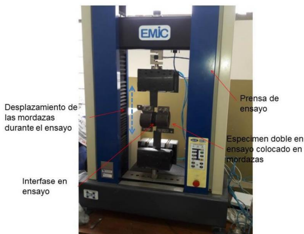
Figura 6. Tipo de ensayo propuesto para generar un esfuerzo de corte en forma estática.
