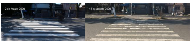
Figura 10. Senda peatonal carriles con sentido de Berisso a La Plata con pintura A2. Fuente: elaboración propia.
