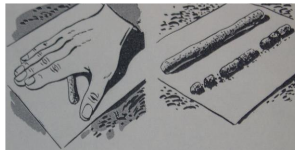
Ilustración 3. Amasado de cilindros durante la ejecución del ensayo para determinar el límite plástico.
