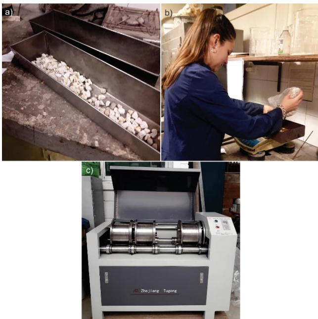
Figura 3. a) Material cuarteado. b) Pesaje del material. c) Equipo para el ensayo Micro Deval, LEMaC.
