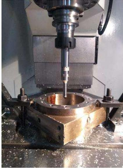
Fig. 12: Herramienta patrón utilizada. (Palpador)
