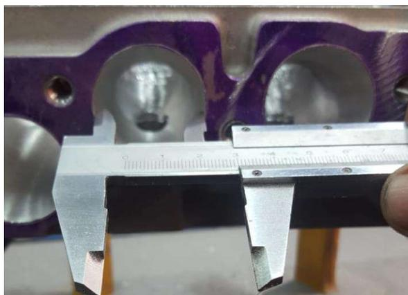
**Imagen 3: Conducto Escape FIAT 1700. Medición de diámetros en proceso de lijado**
