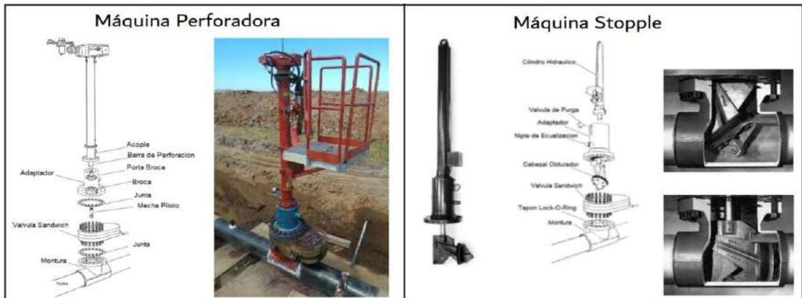
Fig. 14 Máquina Perforadora y Stopple
