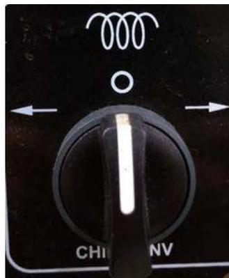
Fig. 7: Interruptor evacuación de viruta.
