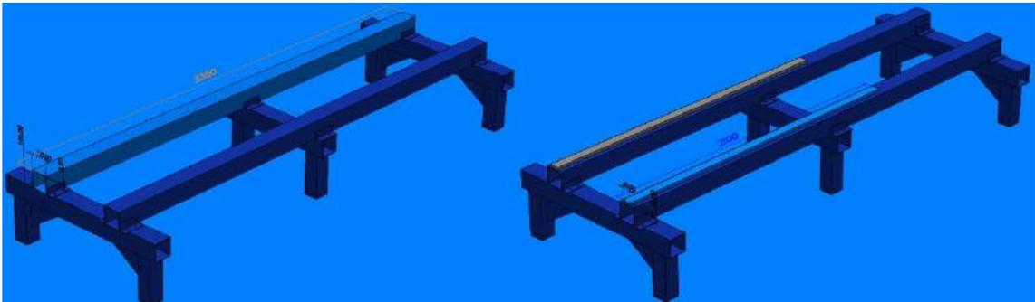
**Figura 3. Dimensiones y disposición de bancadas (izq.) y bancadas de deslizamiento (der.).**
