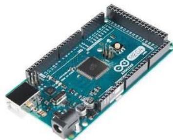
**Figura 3: Arduino Mega**
