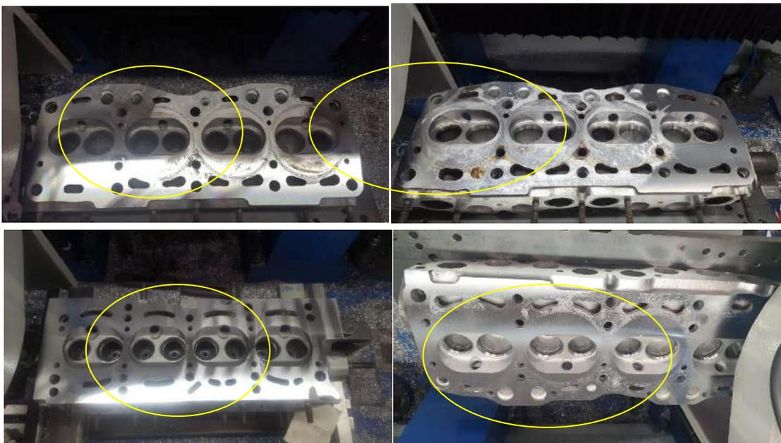
**Imagen 7: Deformaciones de distintas tapas al realizarles el plano principal**
