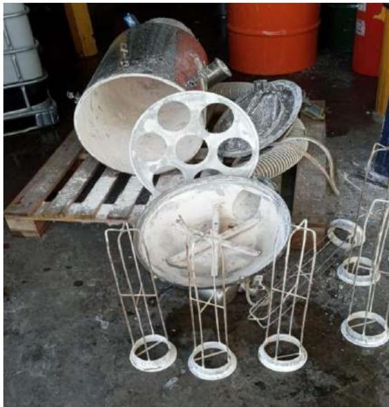
*Figura 3 - Consecuencia de la presencia de vapores en el tanque colector*
