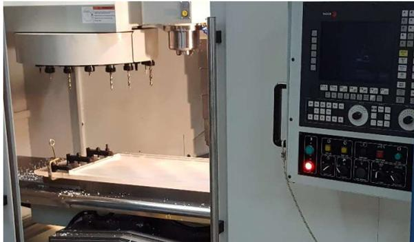
*Vista del centro de mecanizado con una placa terminada*
